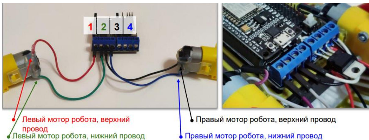
Рисунок 6 – Схема подключение питающих проводов моторов
