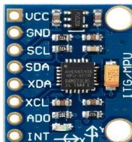
Рисунок 6- Гироскоп-акселерометр GY-521 (MPU 6050)
