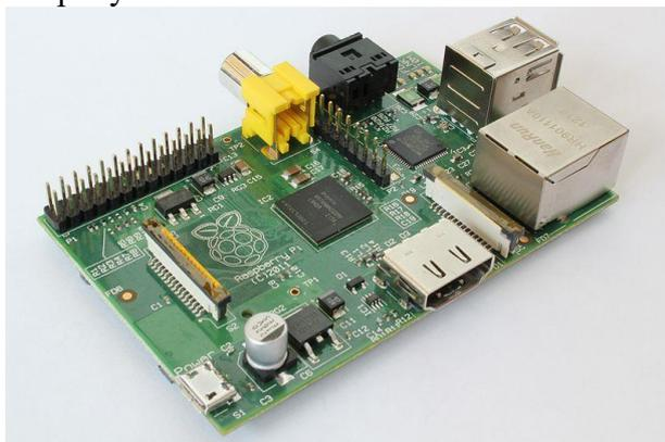
Рисунок 1 - Одноплатный компьютер Raspberry pi
