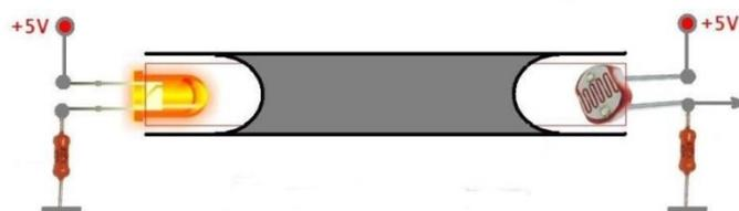
Рисунок 7-Оптический датчик изгиба.
